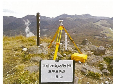
▲基準点測量(GNSS観測)
