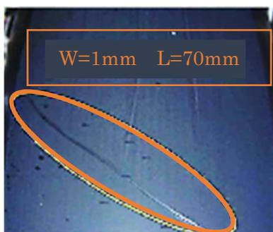
左図はロボットで撮影した動画から切り出した静止画の例です。左図のような保護管表面の近接した画像を撮影でき、丸で囲んだ幅1mmの傷がはっきりと確認できます。
